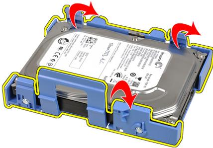
6. Capovolgere il supporto del disco rigido e sbloccare le viti che fissano il disco rigido da 2,5" alla parte inferiore del supporto.
