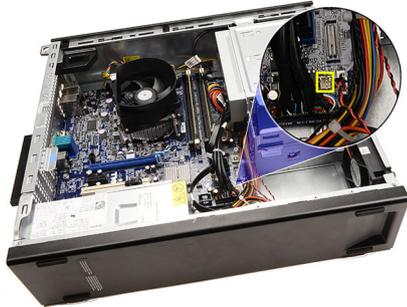
5. Svitare il cavo del sensore termico dai clip del telaio.
