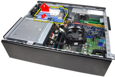
5. Piegare il supporto del disco rigido e quindi rimuovere il disco rigido da 3,5" singolo o i due dischi rigidi da 2,5" dal supporto.
