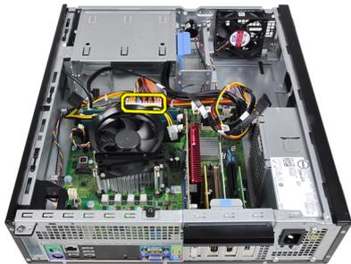
7. Svitare il cavo di alimentazione a 24 piedini dal clip del telaio.
