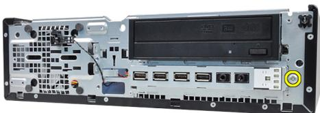
6. Far scorrere il pannello di Input/Output verso la destra del sistema per liberare il telaio.
