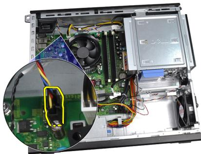
5. Svitare il cavo della ventola di sistema dalle clip del telaio.
